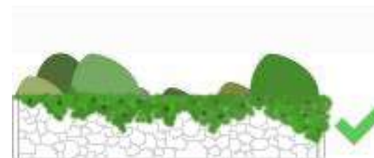
Tömör szárazon rakott kőkerítés, növényzettel befuttatva.
