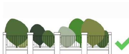
1/3 részben kőlabazat és 2/3 részben áttört kerítés.
